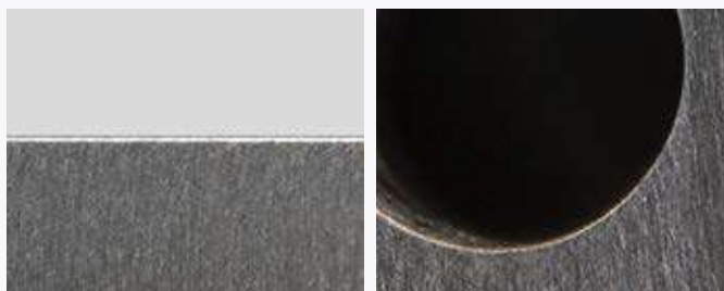
Po obróbce - zadziory zostały stale usunięte, a krawędzie zaokrąglone. Powierzchnia ma jednolity, szczotkowany wygląd.
